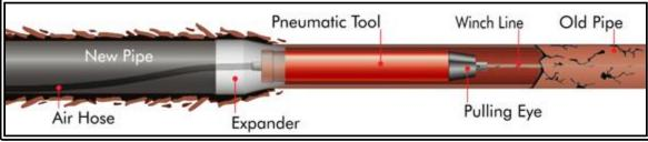
La acción de percusión de la cabeza fragmentada se combina con la tensión del cable, que es insertada a través de la tubería antigua y que se adjunta a la parte frontal de la cabeza fragmentadora. Mantiene la cabeza fragmentadora presionada contra la pared de la tubería existente, y tira la nueva tubería detrás de la cabeza.
