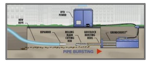
**Importante:** Se debe limitar la velocidad la partícula pico de vibraciones del suelo, resultante de las operaciones en fragmentación de tubería. Si se observan deformaciones en el suelo durante las
