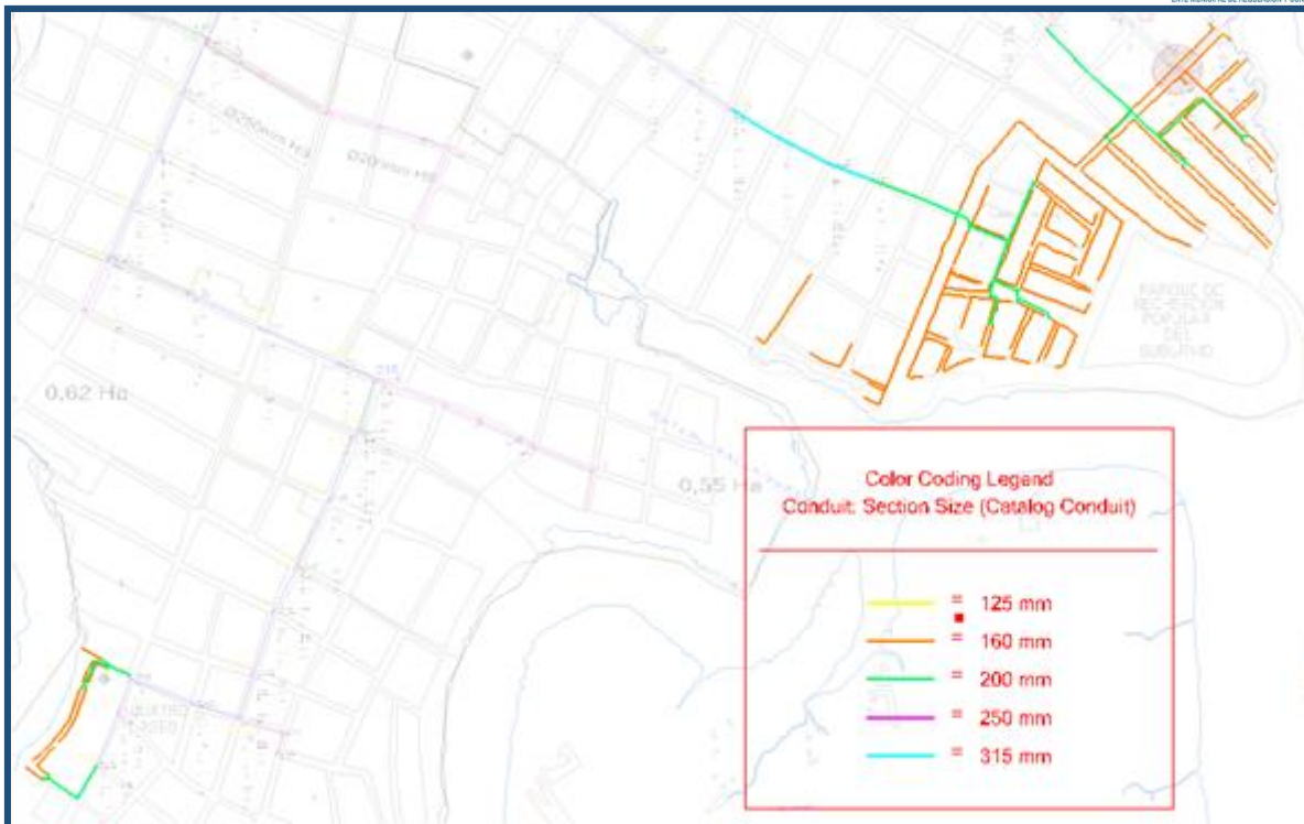
Figura 5.- Distribución de colectores principales y ramales secundarios
